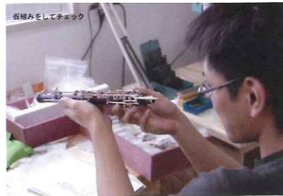
仮組みをしてチェック
